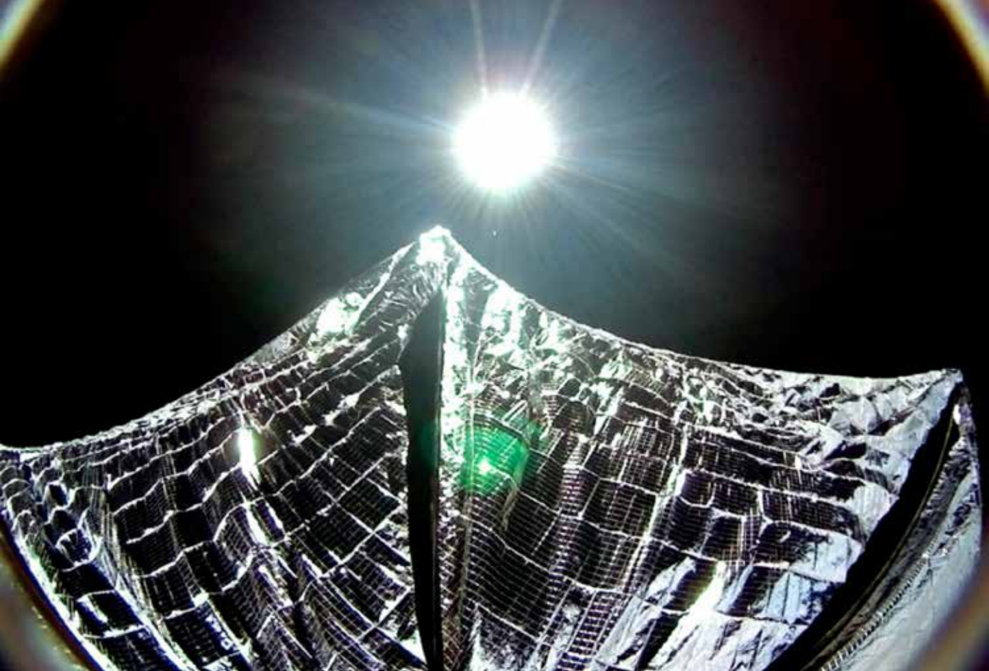
Captura de la vela de la LightSail 1 casi totalmente desplegada en el espacio (foto: sail.planetary.org)
