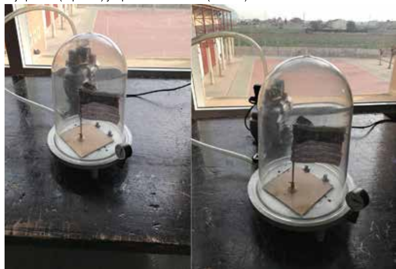
Fig. 2. Bandera ondeante en una campana de vacío. A baja presión (izquierda) y a presión atmosférica (derecha).
